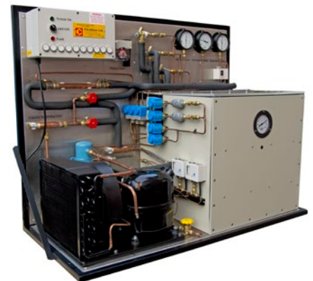
805 Unidad de enseñanza de refrigeración avanzada
