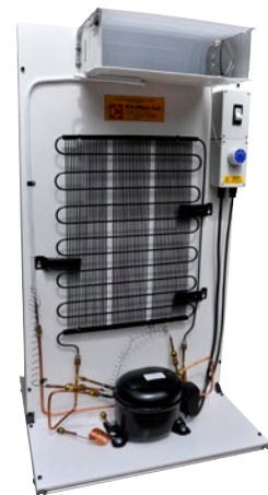
809 Sistema de refrigeración - Doméstico
