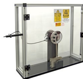
HSM41 Probador de impacto con péndulo (energía de impacto de 25 J)
