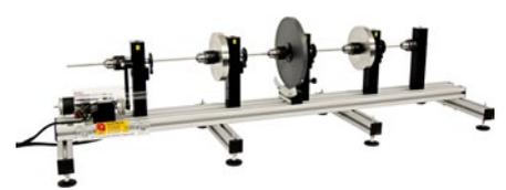
**HVT13 Dispositivo de vibración torsional**
