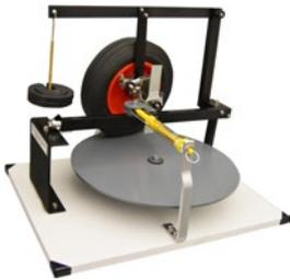
**HTM21 Ángulo del pivote con la vertical en sentido longitudinal, inclinación de las ruedas e inclinación del eje pivotante**
