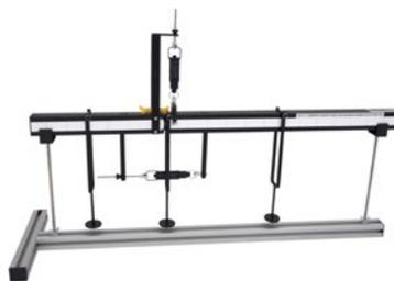
**HFC31** Dispositivo combinado de medición de fuerza cortante y momento flector
