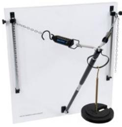
**HFC16** Dispositivo de coeficientes de tensión con juego de pesos incluido
