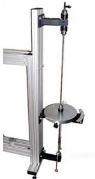
**HVT12B Nota del módulo de oscilación torsional (libre y amortiguada): Necesita el HVT12F para funcionar.**
